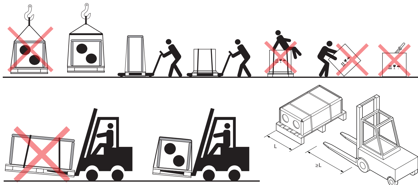
Fig. 4. Exemples de transport au moyen d'une grue, d'un chariot élévateur et d'un transpalette
