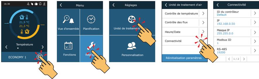
Fig. 48. Visualisation et modification de l'adresse IP à l'aide d'un panneau de commande
