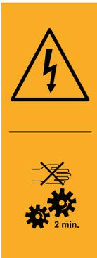
Les symboles indiquent les zones ou les dispositifs à l'intérieur de l'appareil où il existe un risque potentiel d'électrocution ou de dommages à la santé. Les autocollants jaunes se trouvent sur différentes portes, panneaux et couvercles à l'extérieur ou à l'intérieur de l'appareil. Soyez très prudent et utilisez l'équipement de sécurité approprié lorsque vous travaillez à l'intérieur des sections marquées par ces symboles.
