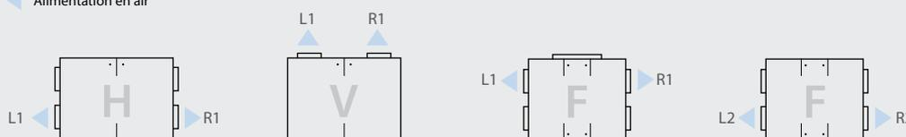
Le côté d'inspection est déterminé par la direction de l'air d'admission, quand on fait face à l'appareil du côté utilisateur.
