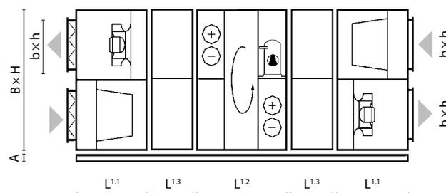
**Remarque :** la longueur et la configuration des sections de réchauffeurs d'air électriques et de réchauffeurs et refroidisseurs d'eau sont indiquées dans le programme de sélection des centrales de traitement d'air VERSO.
