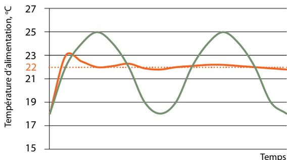
Les compresseurs à vitesse variable sont intégrés aux unités RHP Pro. Le principal avantage de ces compresseurs est leur flexibilité. La vitesse de rotation du compresseur varie, de sorte que l'énergie utilisée est moindre et que les changements de température mineurs se produisent dans les locaux.
