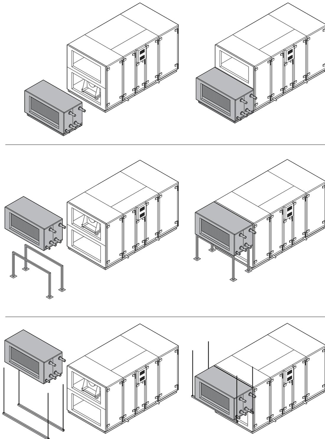
Fig. 24. Exemples d'installations de section chauffage/refroidissement
