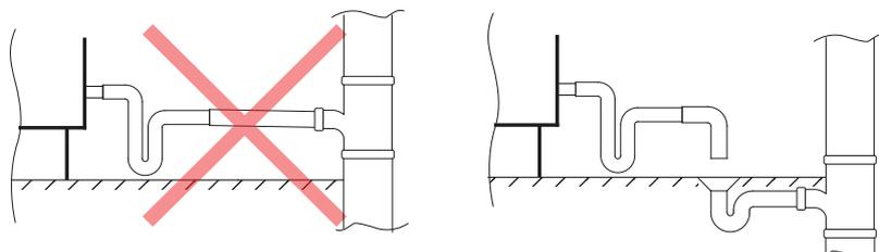
Fig. 30. Raccordement de l'évacuation de la condensation au réseau d'égouts
