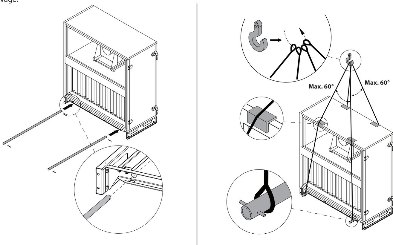
**Fig. 15.** Levage des sections individuelles<sup>1</sup>
