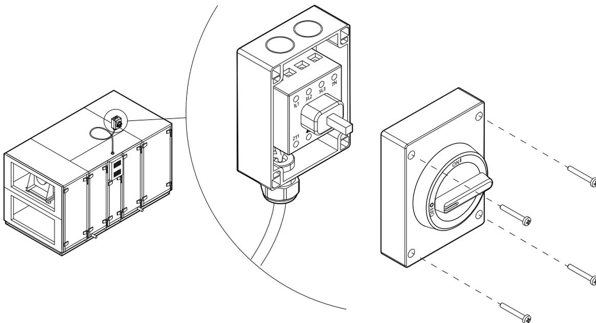
Fig. 35. Disjoncteur de circuit principal
