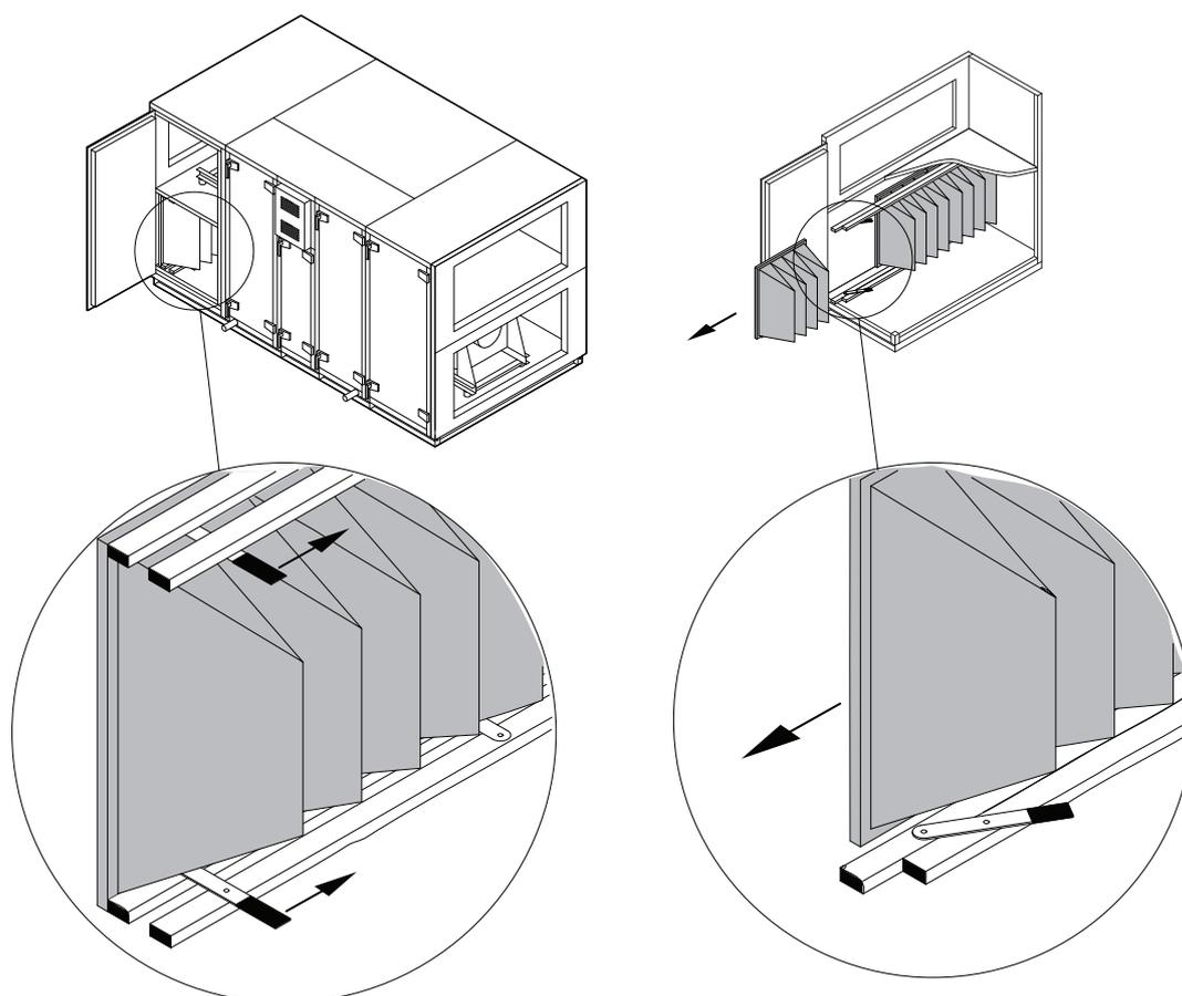
Fig. 52. Dispositif de fixation du filtre
