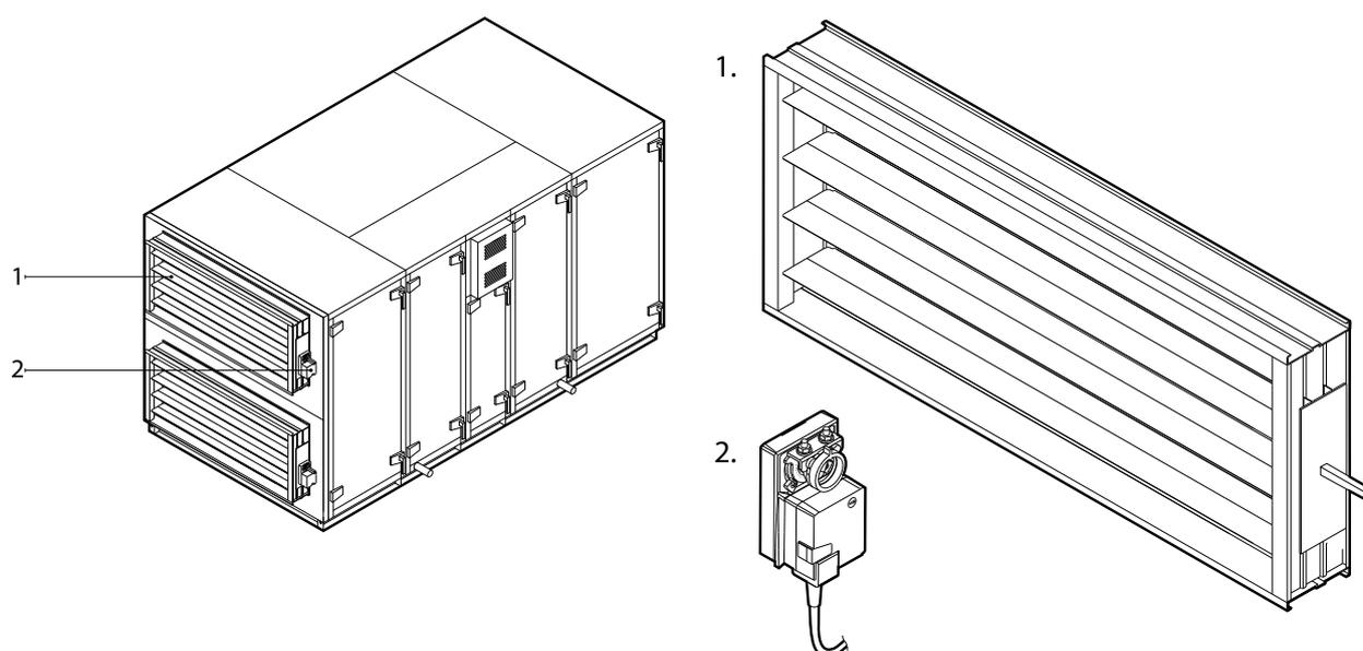
**Fig. 10.** Registre de fermeture d'air
