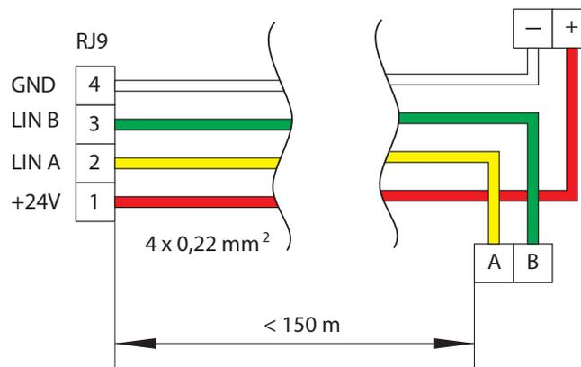
Fig. 45. Schéma de câblage du panneau de commande
