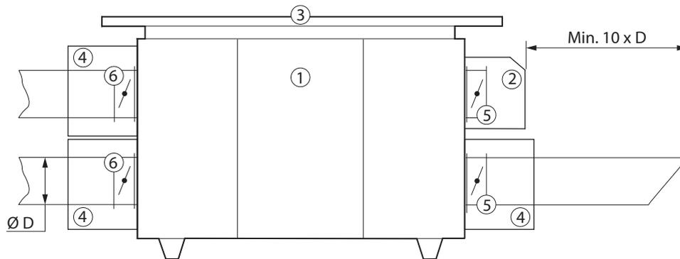
**Fig. 33.** Accessoires des unités à installer à l'extérieur
