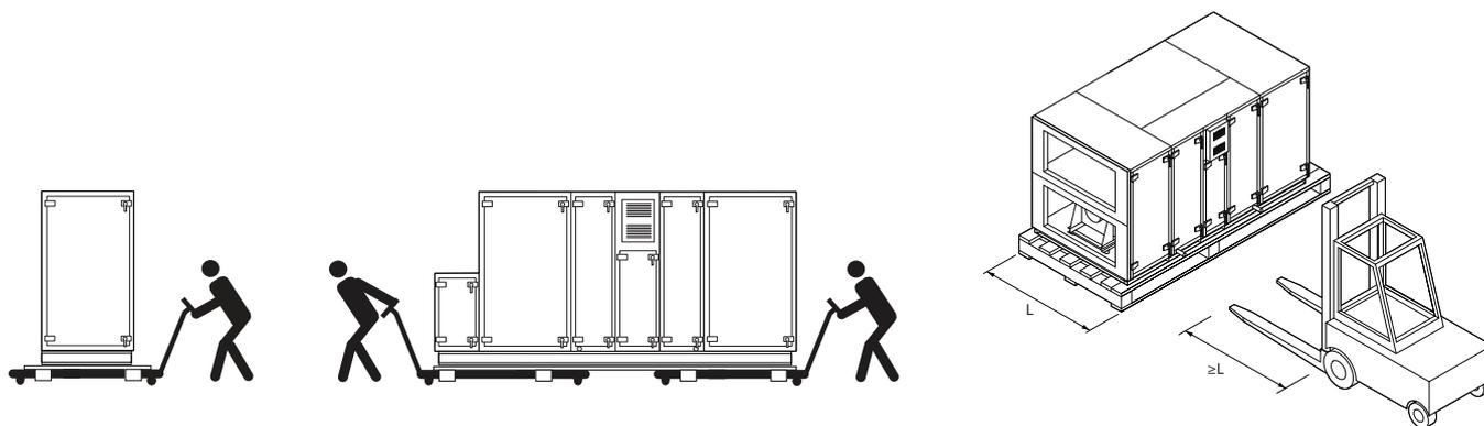
**Fig. 14.** Transport de l'unité à l'aide d'un chariot élévateur à fourche ou d'un chariot
