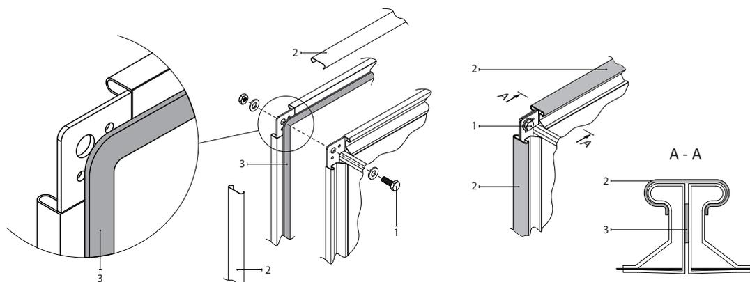
**Fig. 31.** Exemple de fixation et d'étanchéité d'un raccordement de conduites à brides
