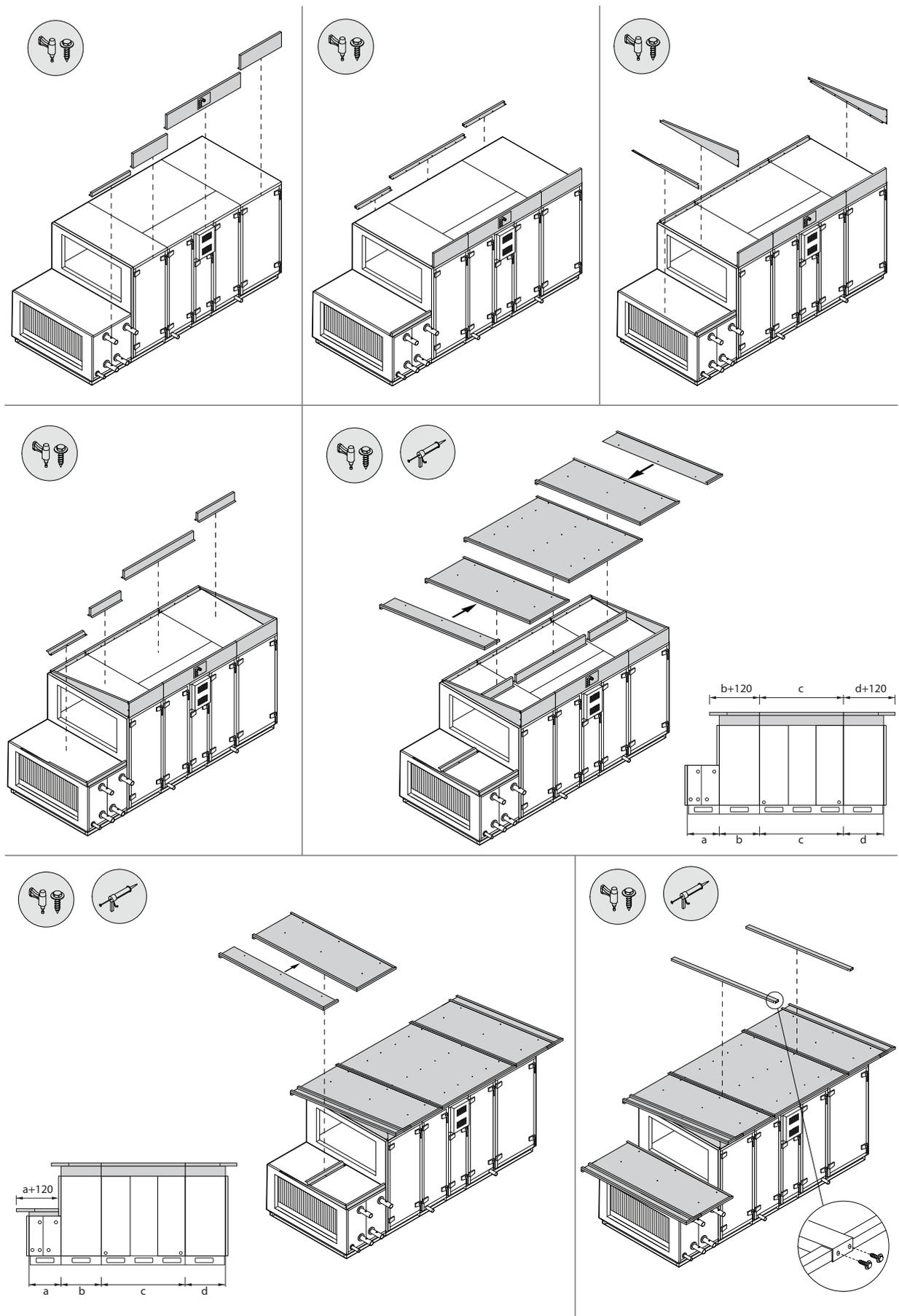
**Fig. 34.** Installation d'un toit de protection commandé séparément <sup>1</sup>
