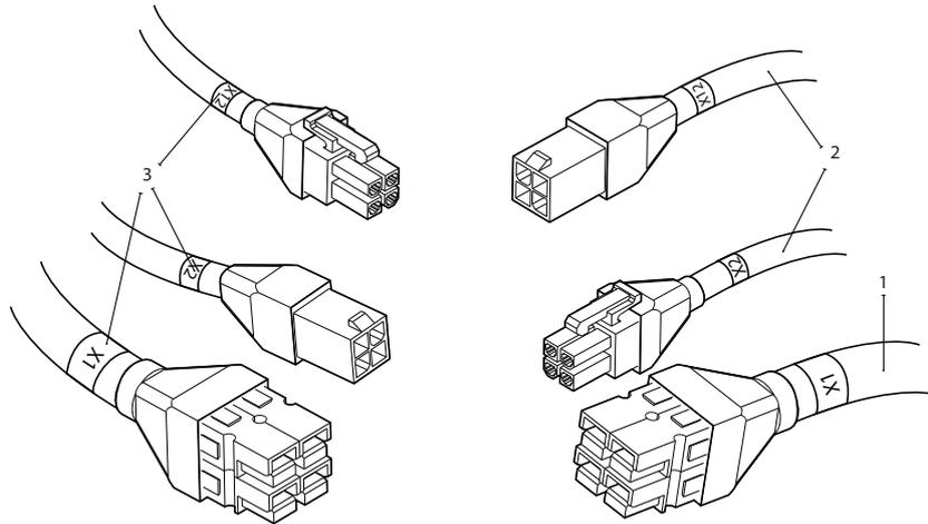
**Fig. 47.** Raccordement des câbles entre les sections
