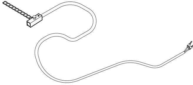
**Fig. 40.** Sonde de température de retour d'eau en surface<sup>1</sup>
