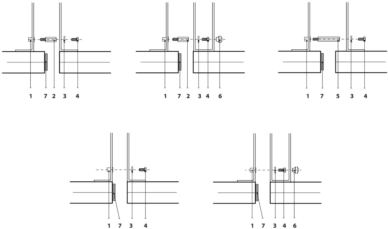
**Fig. 22.** Types de connexions de la section interne
