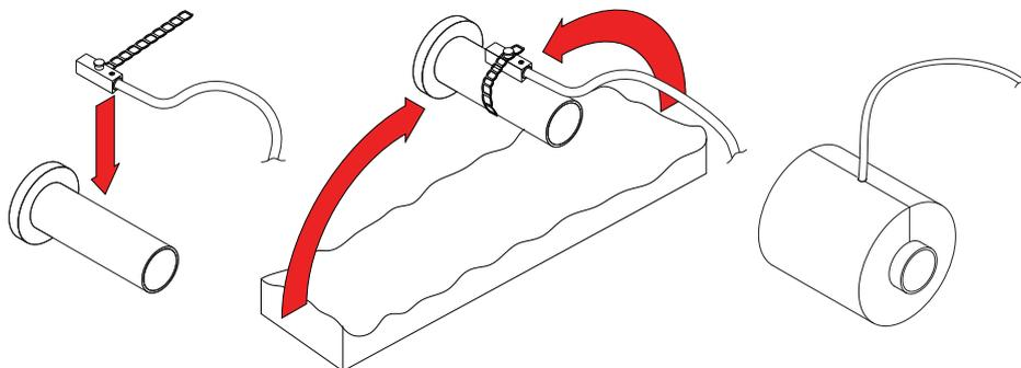
**Fig. 26.** Installation d'une sonde de température de retour d'eau en surface<sup>2</sup>
