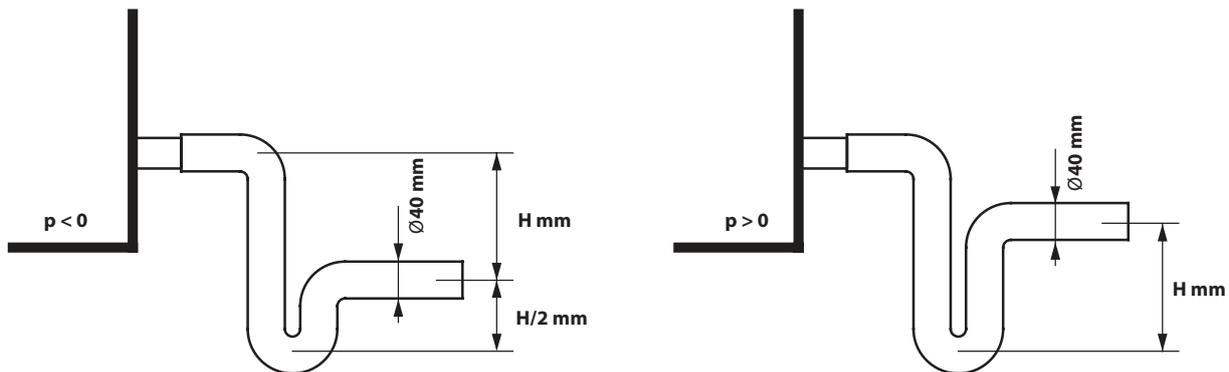
Fig. 28. Installation d'un siphon sans vanne unidirectionnelle
