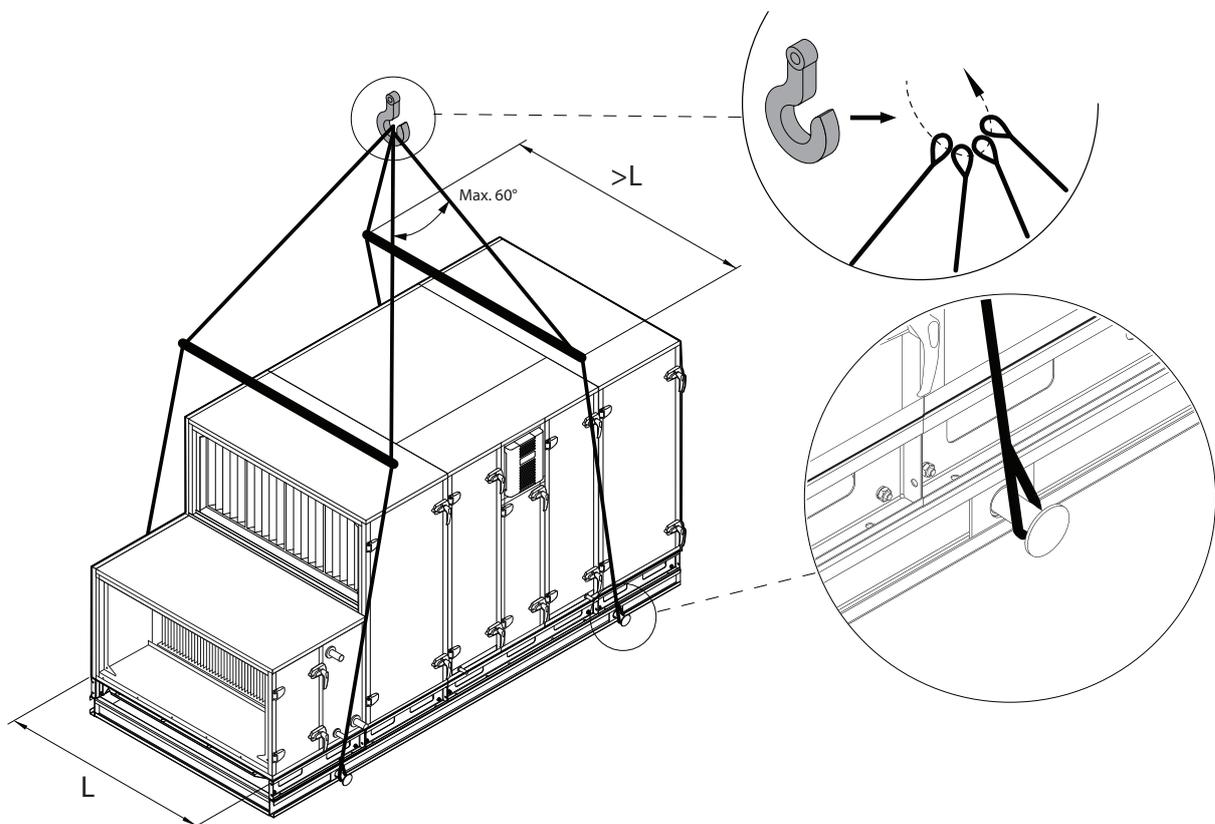
**Fig. 16.** Levage d'une centrale de traitement de l'air entièrement assemblée sur un cadre de levage renforcé<sup>1</sup>
