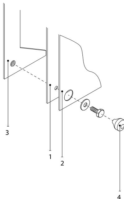
**Fig. 23.** Raccordement interne dans une section ventilateur
