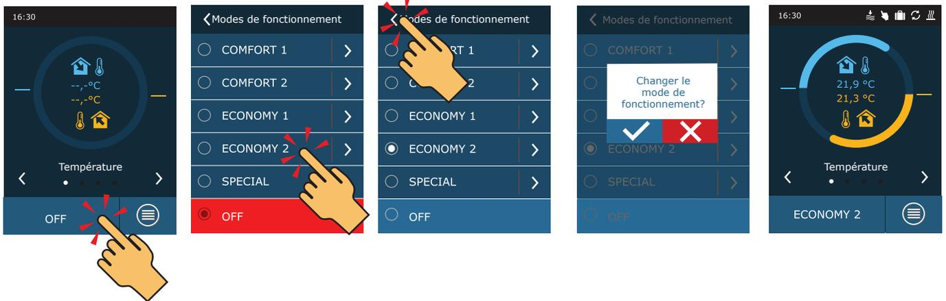
Pendant la première minute de démarrage de l'unité, l'automatisation de l'appareil vérifie les réglages, les composants d'automatisation et ouvre les registres d'air. Plus tard, un signal est envoyé aux ventilateurs et à un échangeur de chaleur, et l'unité commence à fonctionner dans un mode de ventilation sélectionné.
