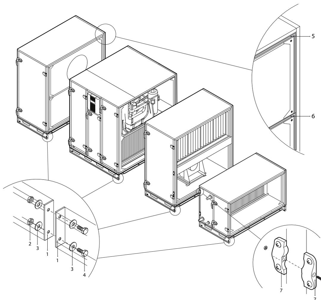
**Fig. 21.** Raccordement externe et scellement des sections
