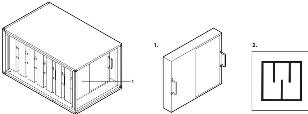
**Fig. 11.** Section de suppression du bruit
