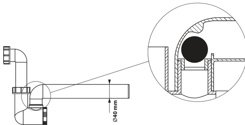
Fig. 29. Exemple d'un siphon avec vanne unidirectionnelle
