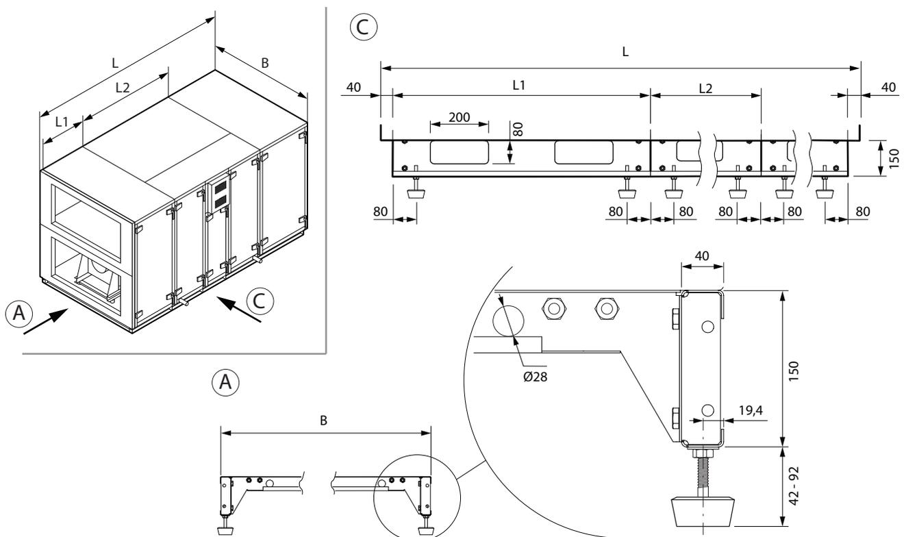
Fig. 17. Cadre d'installation équipé de pieds réglables
