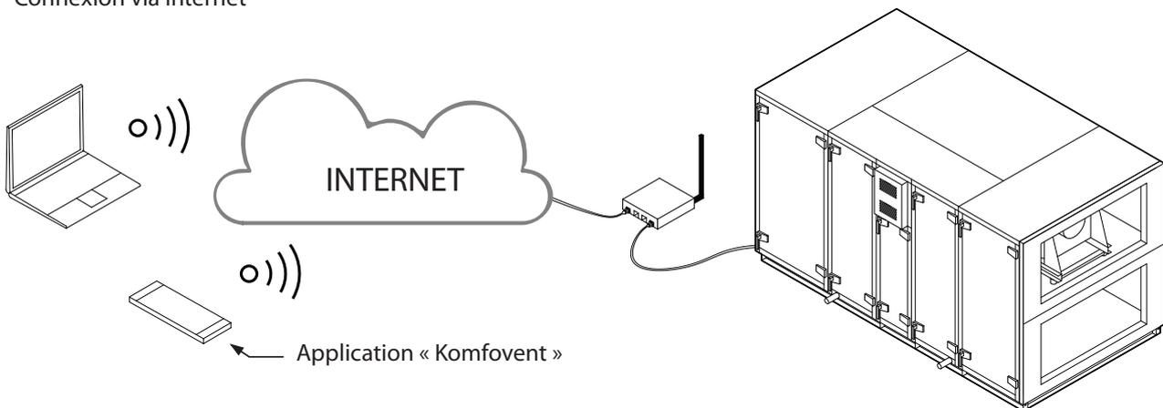
**Fig. 51.** Exemples de connexion des unités de traitement de l'air à l'Internet ou au réseau local
