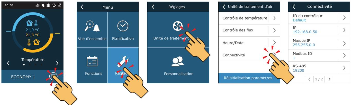
Fig. 21. Visualisation et modification de l'adresse IP à l'aide d'un panneau de commande
