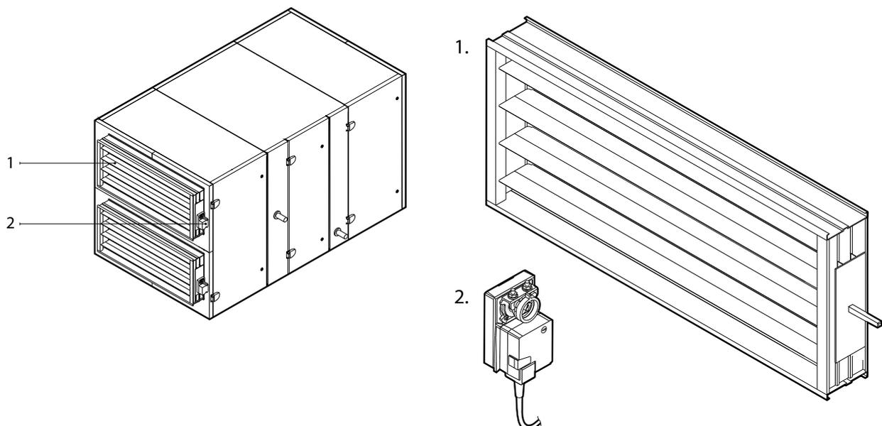
**Fig. 7.** Registre de fermeture d'air
