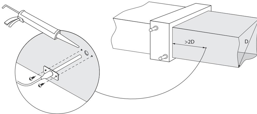
Fig. 36. Installation d'un capteur de température d'air de soufflage
