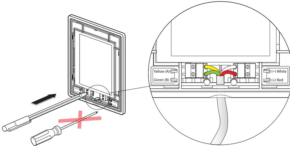
Fig. 38. Câblage du panneau de commande
