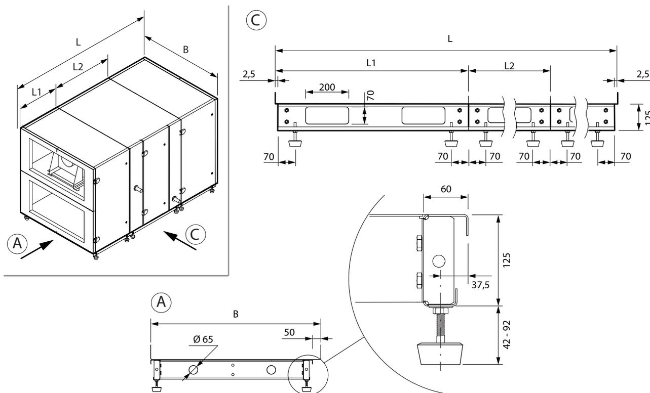
Fig. 13. Cadre d'installation équipé de pieds réglables
