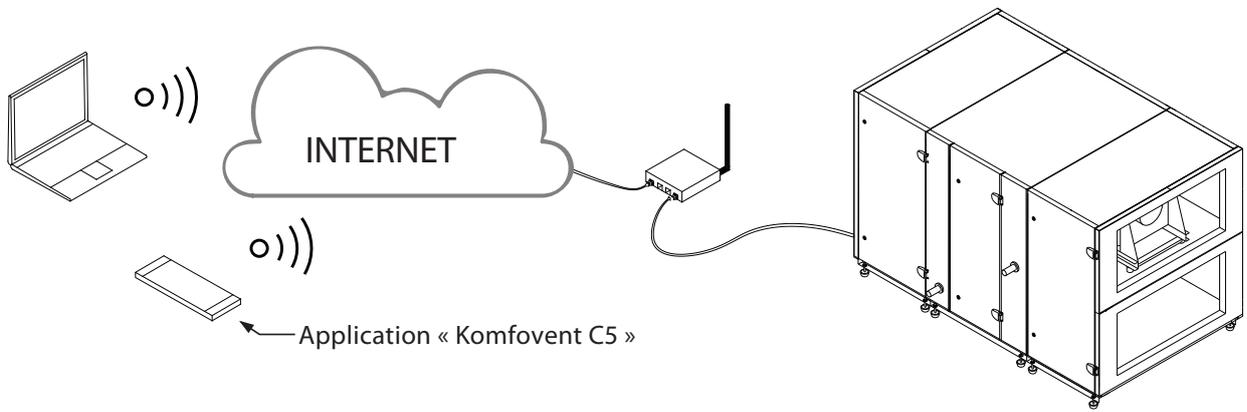
**Fig. 43.** Exemples de connexion des unités de traitement de l'air à l'Internet ou au réseau local
