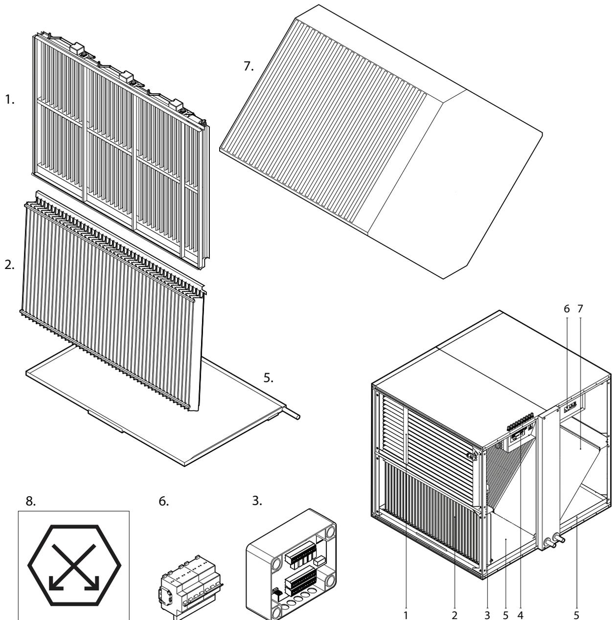
**Fig. 2.** Section d'échangeur de chaleur à contre-courant (CF)
