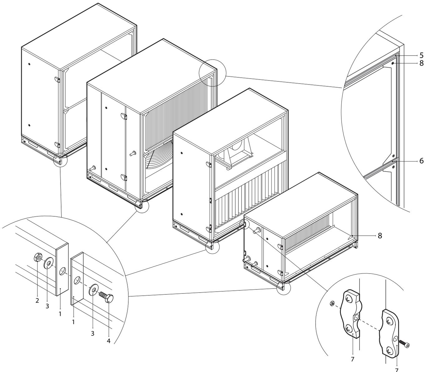
**Fig. 16.** Raccordement externe et scellement des sections
