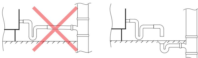
Fig. 23. Raccordement de l'évacuation de la condensation au réseau d'égouts
