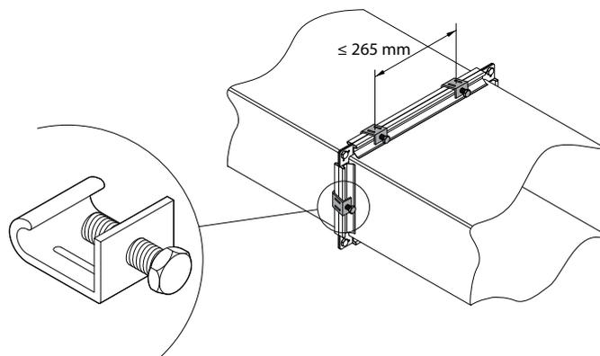
**Fig. 25.** Exemple de raccordement de gaine à l'aide de connecteurs à pince universels
