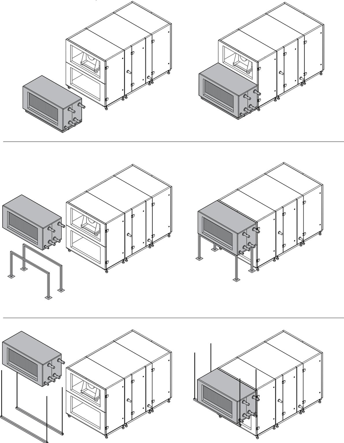
Fig. 17. Exemples d'installations de section chauffage/refroidissement
