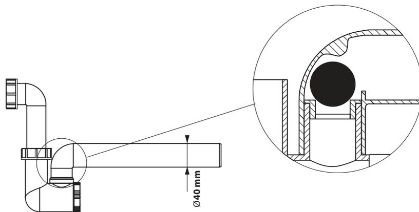
Fig. 22. Exemple d'un siphon avec vanne unidirectionnelle
