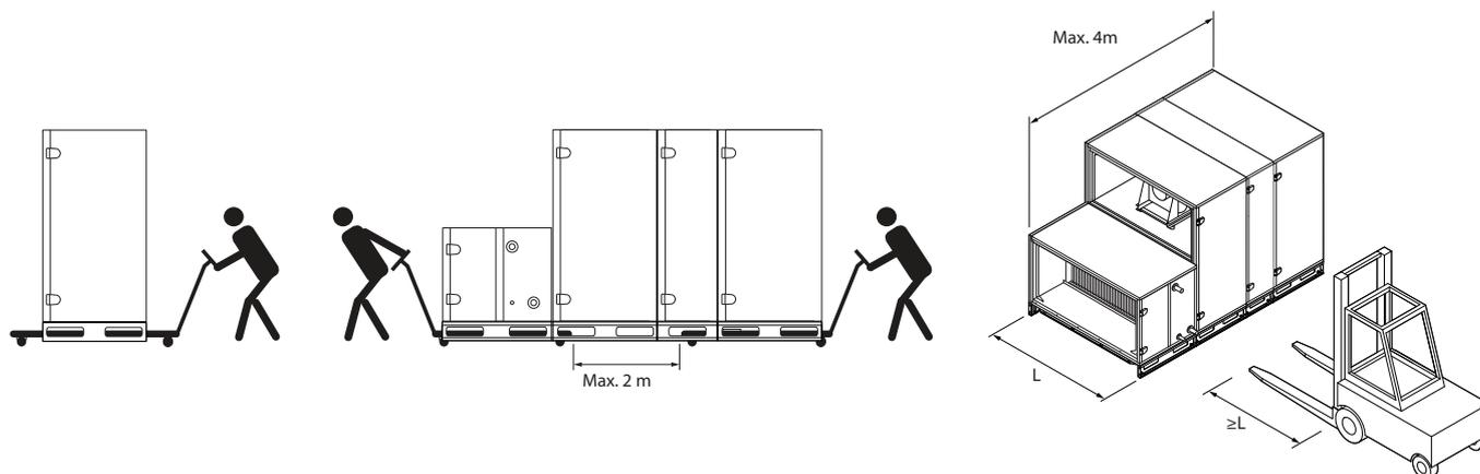
**Fig. 10.** Transport de l'unité à l'aide d'un chariot élévateur à fourche ou d'un chariot
