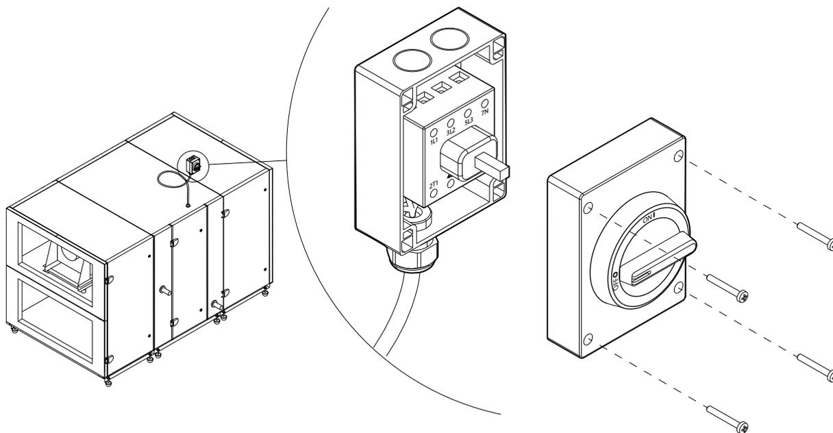
Fig. 28. Disjoncteur de circuit principal
