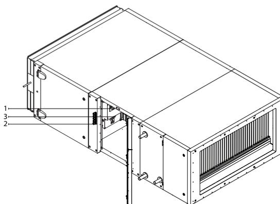
**Fig. 30.** Boîtier d'automatisation
