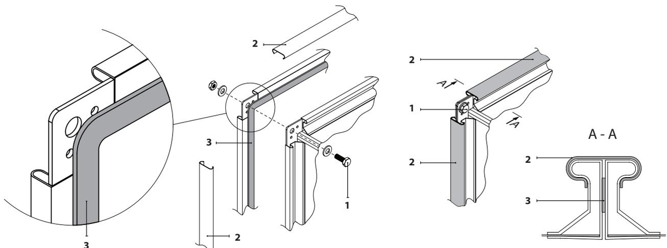
**Fig. 24.** Exemple de fixation et d'étanchéité d'un raccordement de conduites à brides
