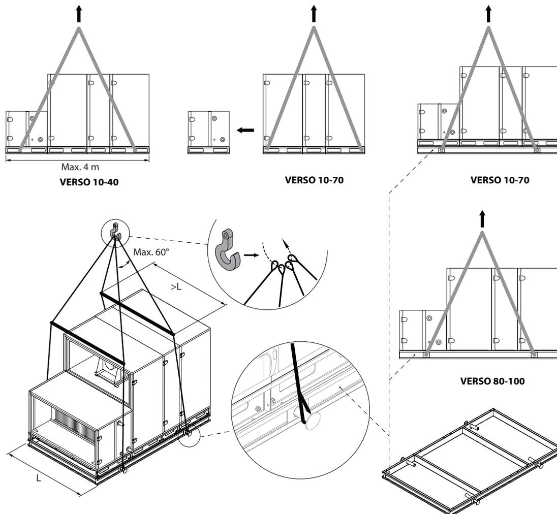
**Fig. 12.** Levage d'une centrale de traitement de l'air entièrement assemblée sur un cadre de levage renforcé<sup>1</sup>
