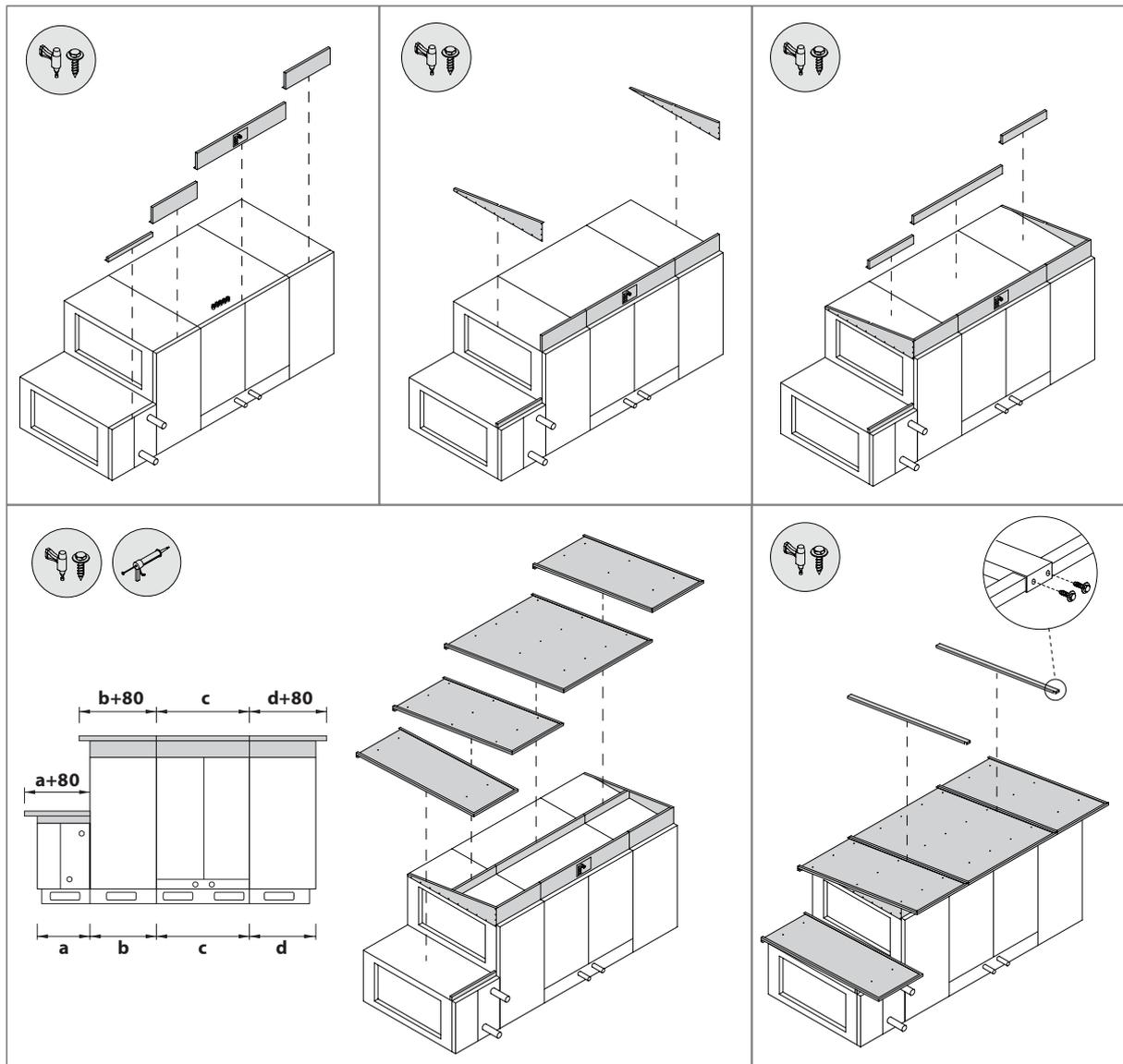
Fig. 27. Installation d'un toit de protection commandé séparément<sup>1</sup>
