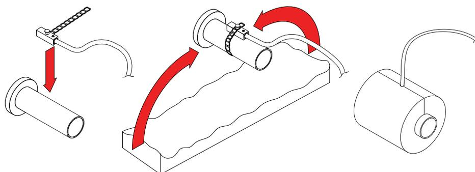
Fig. 19. Installation d'une sonde de température de retour d'eau en surface<sup>2</sup>
