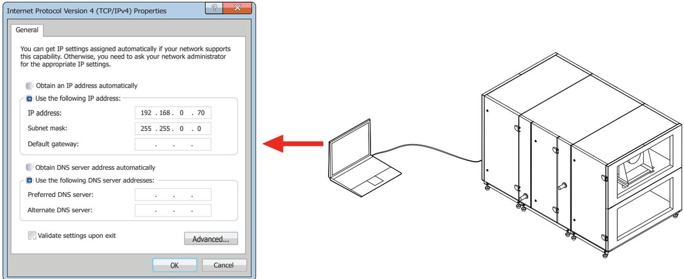
**Fig. 42.** Paramètres du réseau informatique pour une connexion directe à l'unité
