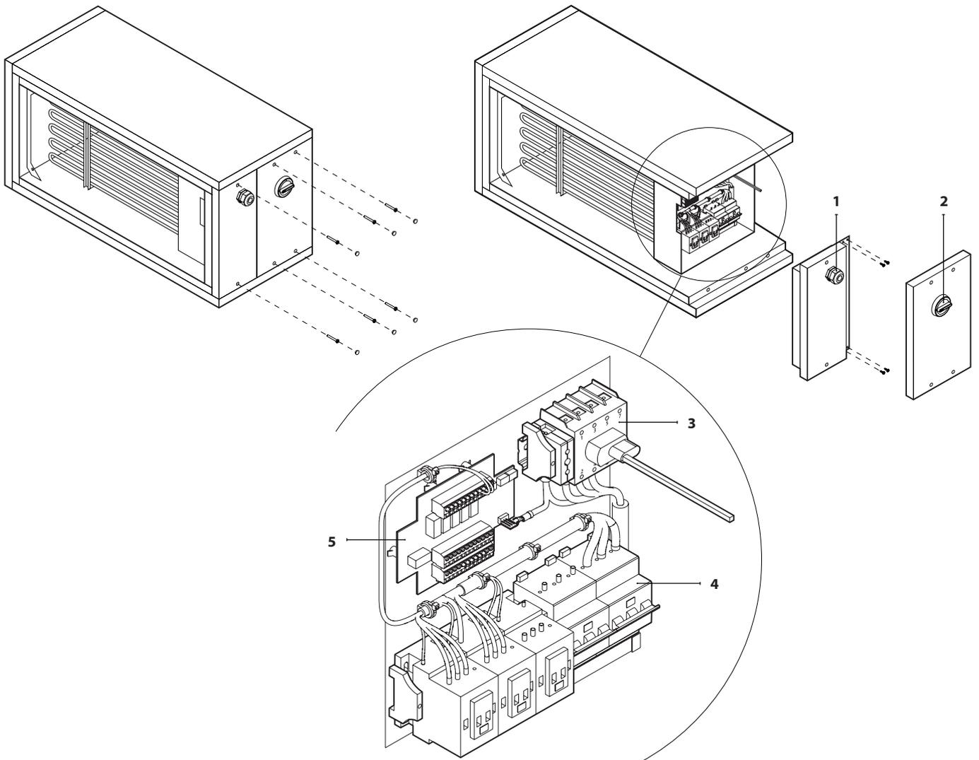
**Fig. 29.** Disjoncteur principal à l'intérieur d'une section de réchauffeur électrique
