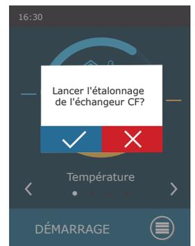
**⚠ Sans étalonnage, l'échangeur de chaleur CF peut prendre en givre et être endommagé lors de basses températures extérieures. ⚠**
