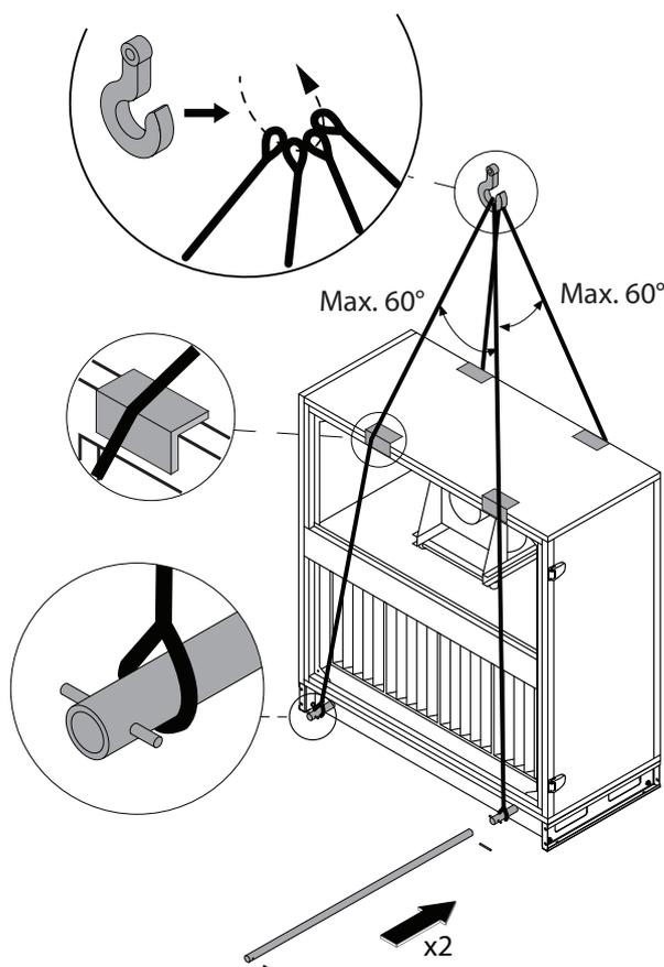
**Fig. 11.** Levage des sections individuelles<sup>1</sup>
