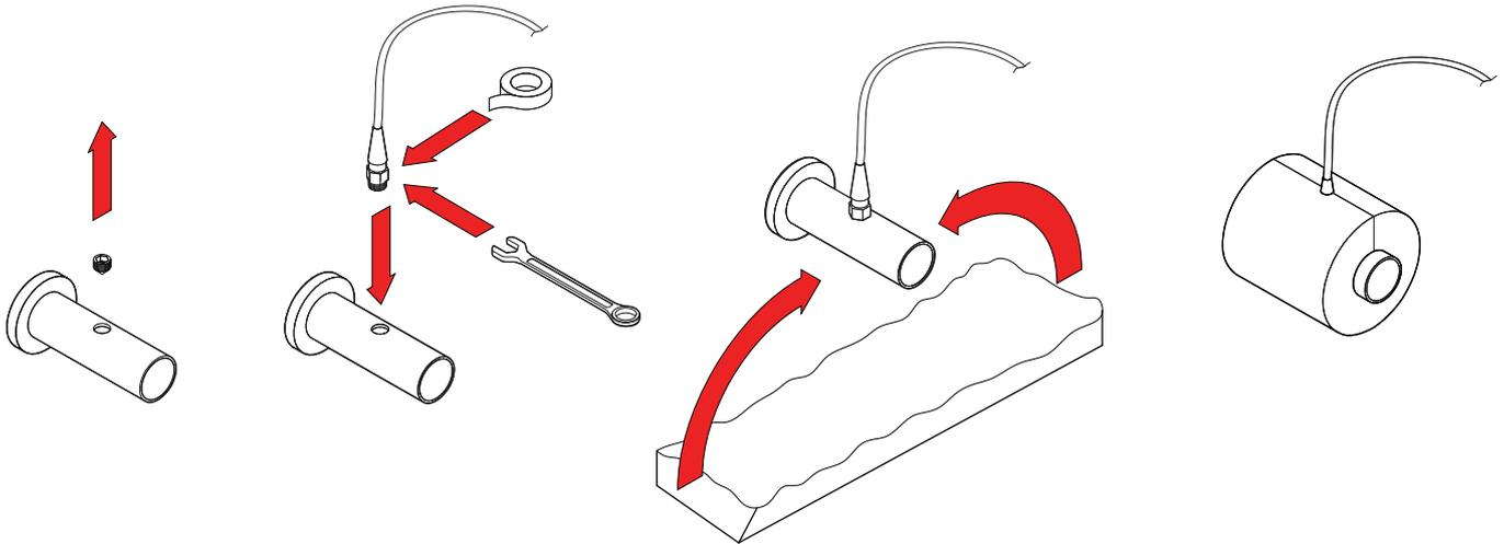
**Fig. 20.** Installation d'une sonde de température de l'eau de retour avec filetage<sup>1</sup>
