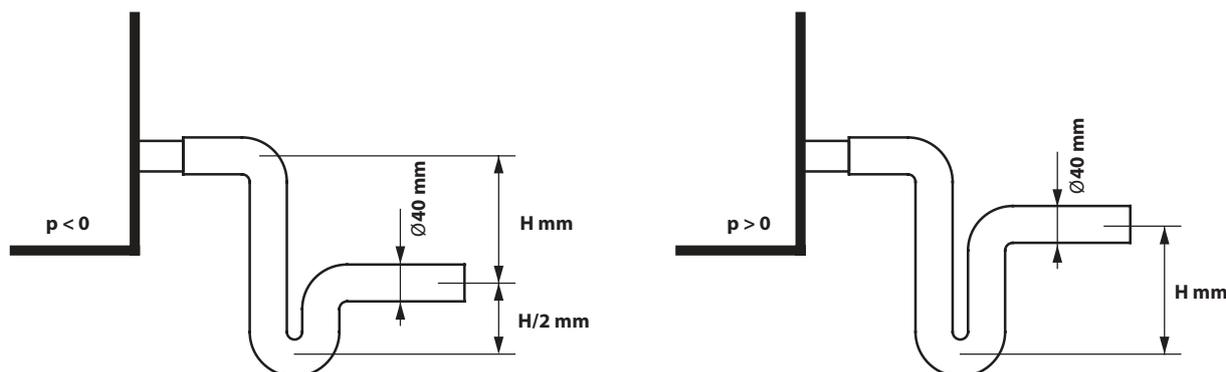
Fig. 21. Installation d'un siphon sans vanne unidirectionnelle
