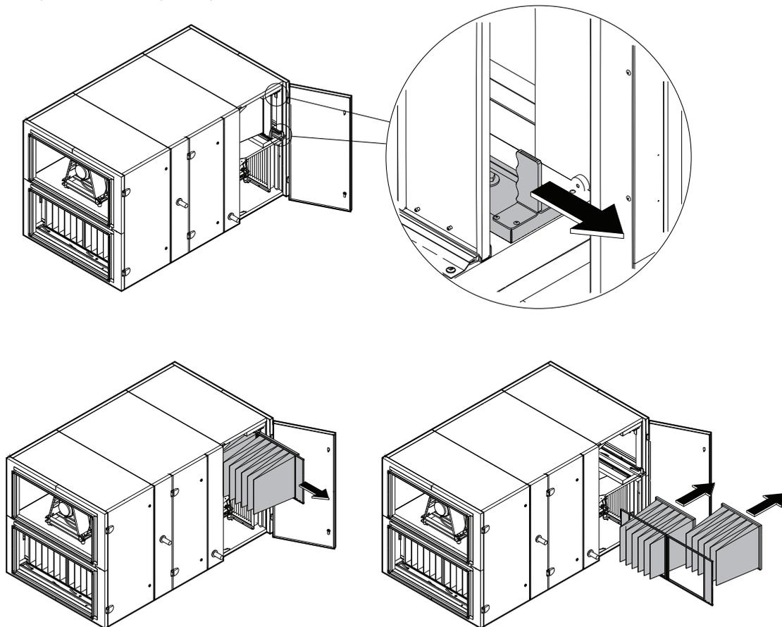
Fig. 44. Dispositif de fixation du filtre
