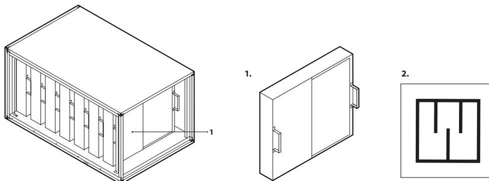
**Fig. 8.** Section de suppression du bruit
