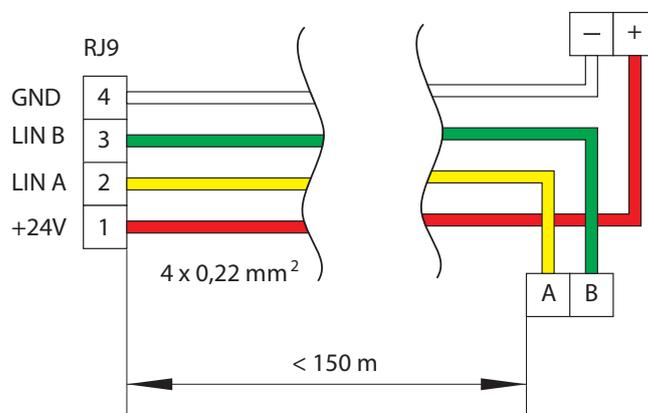
Fig. 37. Schéma de câblage du panneau de commande
