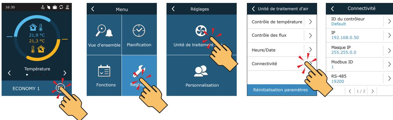
Fig. 41. Visualisation et modification de l'adresse IP à l'aide d'un panneau de commande
