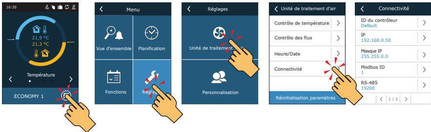
Fig. 29. Visualisation et modification de l'adresse IP à l'aide d'un panneau de commande
